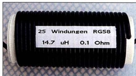
Bild 2: Koaxial-Balun auf einem 50-mm-Installationsrohr
