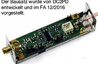
Erweitern Sie Ihren Red Pitaya zum SDR-Empfänger oder -Transceiver! Die Bandbreite der Baugruppe beträgt 60 MHz, die Verstärkung ist elektronisch einstellbar (I2C-Bus). Lieferumfang: SMD-bestückte Platine, SMA-Anschlussbuchse und SMA-Kabel, alle bedrahteten Bauteile, Weißblechgehäuse und Bauanleitung.
