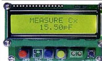
Einbaufertiges, geprüftes LC-Meter-Modul mit beleuchtetem Display.
