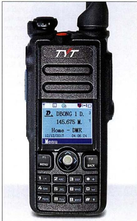
**Bild 1:** Mit Farbdisplay und Tastatur erweist sich der kompakte Duobander als gut bedienbar. Fotos: DL1YBL
