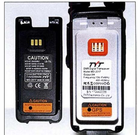
**Bild 3:** Lithium-Ionen-Akkumulator und Geräte rückseite mit Rastmechanismus
