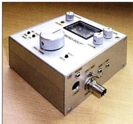
Blick auf eines der beiden Muster des kompakten 8-Band-QRP-Transceivers Micro-Solf von DK1HE
