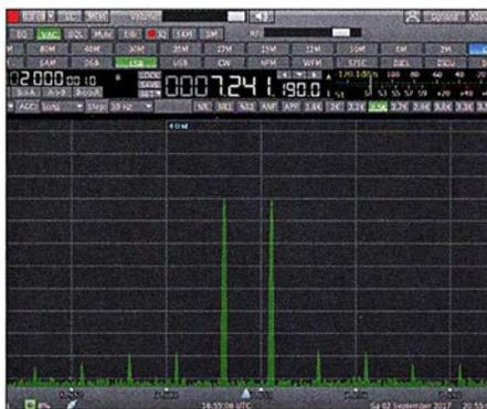
Bild 28: Das entsprechende Messergebnis bei  $P_e = 2 \cdot (-40 \text{ dBm})$  zeigt  $\Delta IM_3 = 68 \text{ dB}$  und  $IM_3 = -6 \text{ dBm}$ .
