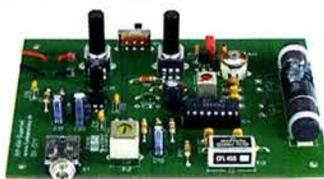
Bausatz für einen 49-m-AM-Superhet auf Basis des TCA440. Leicht aufzubauen, da ausschließlich bedrahtete Bauelemente eingesetzt werden und lediglich der Ferritstab zu bewickeln ist. Das ideale Bastelprojekt für OV's und Jugendgruppen! Lieferumfang: Platine und sämtliche Bauteile (ohne 9-V-Blockbatterie)
