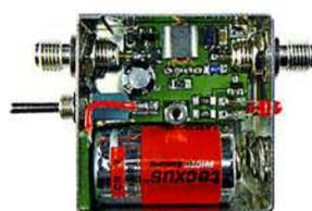
LW/MW/KW-Vorverstärker für Handfunkgeräte und -scanner usw. nach Jo Becker, DJ8IL (FA 8/2011). SMD-Teile müssen bei diesem Bausatz selbst bestückt werden. Komplettbausatz mit Platine, allen Bauteilen, SMA-Buchsen, Batterie sowie einem bearbeiteten Weißblechgehäuse
