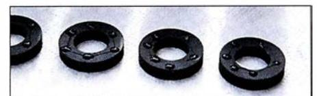
**Bild 6:** Vorbereitung zum Aufkleben – Ringkerne mit einigen Klebertropfen
