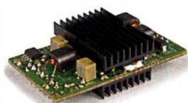
Bausatz nach H. Arnold, DL2EWN, (FA 2/2016) für einen besonders intermodulationsarmen 5-W-Linearverstärker ( $G_p=23$  dB) bestehend aus einer SMD-vorbestückten Platine sowie allen erforderlichen aktiven und passiven Bauelementen sowie 4 Kühlkörpern.
