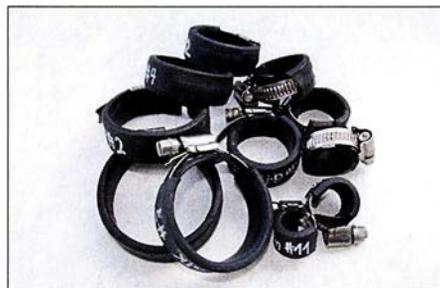
**Bild 38: Schellensatz zur Sicherung des Schiebemastes gegen Zusammenrutschen**
