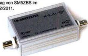
Ein SO42P und ein 10-MHz-Quarz setzen den LW-Bereich von 10 bis 500 kHz auf 10,01 bis 10,5 MHz um. Durchgangsverstärkung 10...15 dB. Betriebsspannung 12 V. Bausatz komplett mit Platine, bearbeitetem Gehäuse und ausführlicher Anleitung
