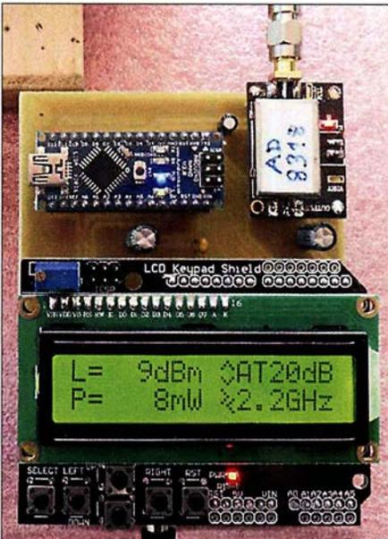
Bild 1: Aufbau der drei Module des Pegelmessers auf der Grundplatte Foto: DC5ZM
