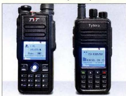
Waren FM/DMR-Handfunkgeräte bislang Monobander, so ist mit dem Tytera MD-2017 ein Duobander im deutschen Fachhandel preisgünstig erhältlich. Es handelt sich wie bei allen DMR-Geräten um ein Betriebsfunkgerät, das durch Programmierung für Amateurfunkzwecke anzupassen ist. Das Bild zeigt links das MD-2017 im Vergleich zu seinem Vorläufer, dem Monobander Tytera MD-380.
