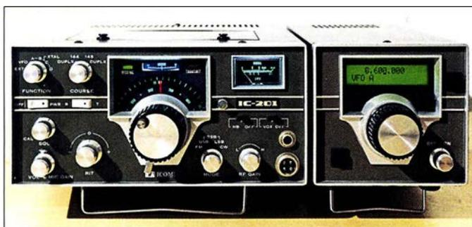
Bild 1: 2-m-Allmode-Transceiver IC-201 mit selbst gebautem externem Digital-VFO
