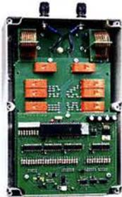
Nach dem großen Erfolg des 1-kW-Kopplers BX-1000 war es für N. Graubner naheliegend, eine abgespeckte Version für „normale“ Transceiver mit 100 bzw. 200 W Sendeleistung zu entwickeln. Wir liefern einen Komplettbausatz mit gewickelten Spulen, teilbestückten Platinen, Porzellan-HF-Durchführungen, bearbeitetem Gehäuse und ausführlicher Anleitung.
