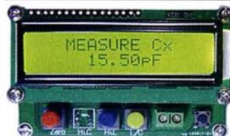
Einbaufertiges, geprüftes LC-Meter-Modul mit beleuchtetem Display. Messbereiche: 1 pF-10 µF, 1 nH-100 H, Stromversorgung +5 V/20 mA über USB- oder DC-Buchse
