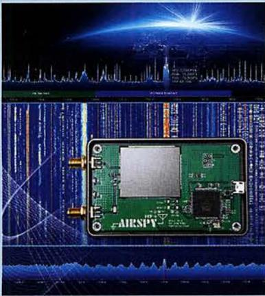
Einen neuen Ansatz für SDRs verfolgt der ab S. 118 beschriebene Airspy HF+. Er verwirklicht das altbekannte Direktmisch-Konzept in Digitaltechnik und nutzt hierfür einen neuartigen, hochintegrierten IC-Baustein für Autoradios. Dieser ermöglicht es, Bandfilter und mitlaufende Vorselektion ohne Spulen und ausschließlich „in Silizium“ zu realisieren – ein Konzept, das ein neues Kapitel auch im Preis-Leistungs-Verhältnis aufschlägt.
