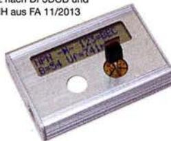
Verbesserte Version des Bausatzes nach DF3DCB/DH8GHH. Jetzt mit 3,7-V-Lilou-Akkumulator, beleuchtetem LC-Display und neuer Firmware. Lieferumfang: SMD-bestückte Platine, Buchsen, Display, Akku, bearbeitetes Gehäuse und ausführliche, reich bebilderte Bauanleitung.
