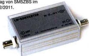
Ein SO42P und ein 10-MHz-Quarz setzen den LW-Bereich von 10 bis 500 kHz auf 10,01 bis 10,5 MHz um. Durchgangverstärkung 10...15 dB. Betriebsspannung 12 V. Bausatz komplett mit Platine, bearbeitetem Gehäuse und ausführlicher Anleitung
