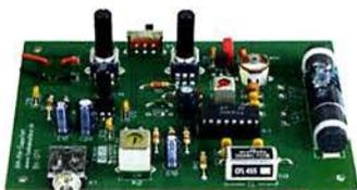
Bausatz für einen 49-m-AM-Superhet auf Basis des TCA440. Leicht aufzubauen, da ausschließlich bedrahtete Bauelemente eingesetzt werden und lediglich der Ferritstab zu bewickeln ist. Das ideale Bastelprojekt für OV's und Jugendgruppen! Lieferumfang: Platine und sämtliche Bauteile (ohne 9-V-Blockbatterie)
