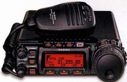
Der kleinste HF/VHF/UHF-Mobil-Transceiver Liefert Basisstationsleistung in einem kompakten Paket
