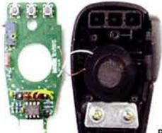
Nützliches Zubehör für Funkamateure, die auf den VHF/UHF-Bändern in SSB arbeiten, da die Gegenstation am Ende des Sendedurchgangs einen besonderen Piepton bzw. eine Tonfolge hört und dadurch weiß, dass sie jetzt senden soll.
