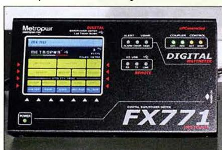
Das Metropwr FX771 ist die Anzeige- und Steuereinheit eines Messsystems, das sich mit seinem umfangreichen externen Zubehör für vielfältige anspruchsvolle Mess- und Schaltaufgaben zwischen Transceiver und Antennenanlage eignet. Außerdem lässt sich ein Wattmeter Bird 43 ins Messsystem integrieren oder dessen Messwerte sind über ein USB-Interface auf dem PC anzeigbar.
