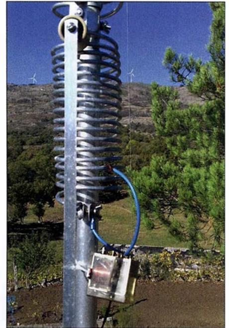
Bild 6: Mit einem Relais werden 2,5 Wdg. der 80-m-Spule kurzgeschlossen.
