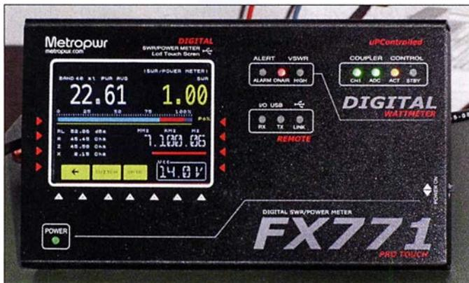
Bild 1: Anzeige- und Bedieneinheit FX771 mit Touchscreen
