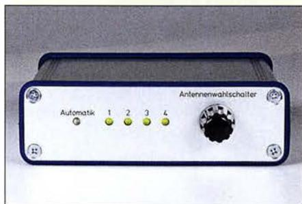
Das vorgestellte Interface erlaubt die Steuerung eines räumlich abgesetzten Antennenumschalters durch das FA-Bausatzgerät FA-AS, an dem nun nicht nur Icom-, sondern auch Yaesu-Transceiver betrieben werden können. Schaltbefehle, die via USB von der Logsoftware UcxLog kommen, kann das Interface ebenfalls verarbeiten.
