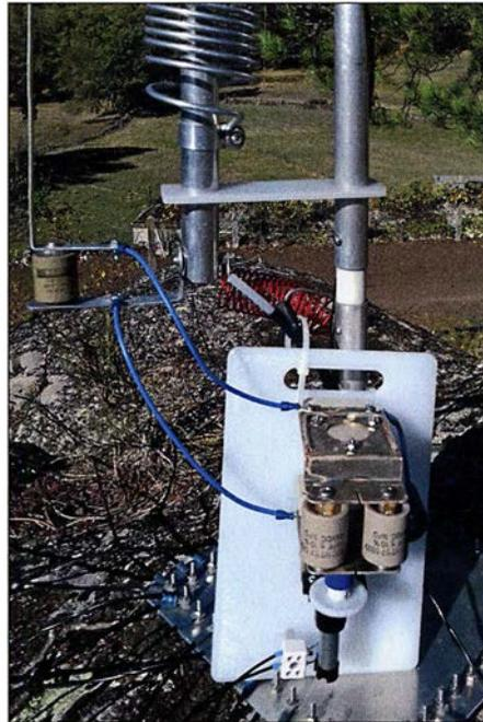
Bild 5: Die 160-m-Modifikation wird anstelle eines Festkondensators eingefügt.
