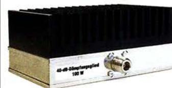
Bausatz für einen bis 150 MHz nutzbaren 50-Ω-Abschlusswiderstand, der für Messzwecke über einen -40 dB-Ausgang (BNC) verfügt. Eingangseitig hat der Dummyload eine N-Buchse. Komplettbausatz mit bearbeitetem Gehäuse und großem Kühlkörper.
