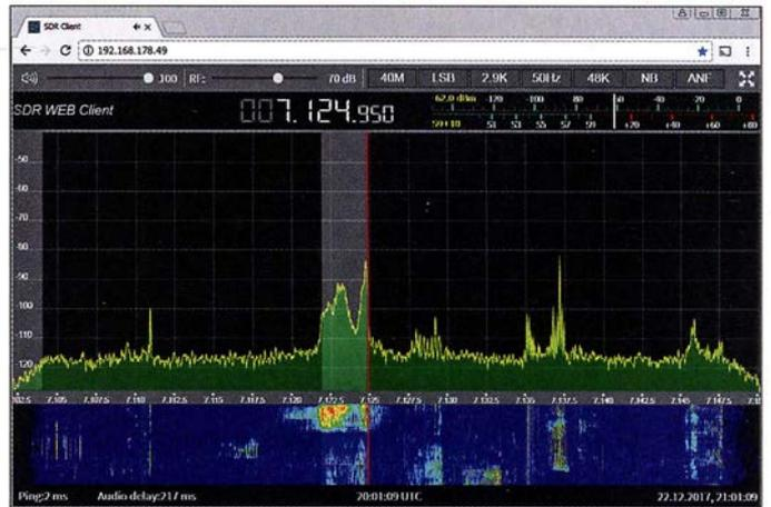
Bild 16 zeigt den gestarteten Colibri-Nano an einem Windows-PC unter dem Google-Chrome-Browser (der Internet-Explorer ließ sich nicht verwenden). Auch Smartphone und Tablet-PC sind nutzbar, eine spezielle App ist hierfür nicht erforderlich. Zusätzlich liefert der Hersteller die Remote-Client-Software zur Installation auf einem PC oder Notebook [4]. Nach dem Start von *Expert SDR2 Remote* wird der Colibri-Nano vom PC im Netzwerk gefunden und kann über *Options* genau eingestellt werden.
