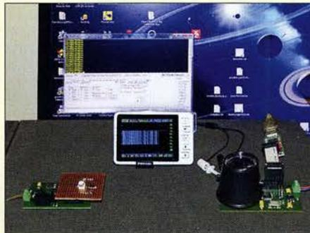
Statt einer Funkverbindung über WLAN oder Bluetooth bietet sich für eine drahtlose Datenübertragung die Nutzung von Infrarotdioden an. Je zwei der im Beitrag vorgestellten Baugruppen ermöglichen schon ohne den Einsatz von Linsen Reichweiten von mehr als 100 m.
