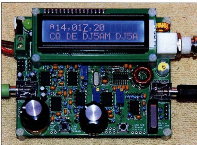
**Bild 1:** Komplett aufgebauter Transceiver QCX, hier die 20-m-Version, mit eingeschaltetem CW-Decoder
