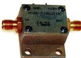
Für Messzwecke und viele andere Anwendungen. Frequenzbereich 20 bis 6000 MHz, Verstärkung typ. 13 dB, SMA-Buchsen, Abmessung 26 x 27 x 15 mm. Betriebsspannung 12 V, max. 50 mA. RoHS-konform, ungebraucht, Listenpreis \$ 114,95
