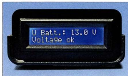
Bild 7: Ausgabe von aktueller Akkumulatorspannung und Betriebszustand
