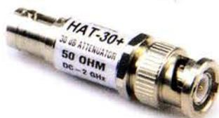
Kommerzielle Dämpfungsglieder von Mini-Circuits für DC bis 2 GHz, BNC-Stecker/-Buchse (m/f), maximale Eingangsleistung 1 W bzw. 0,5 W.
