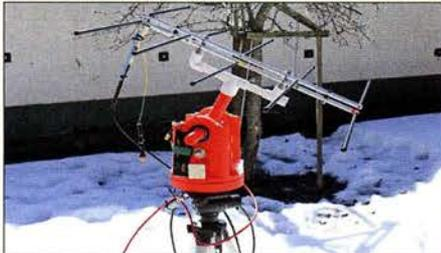
3-D-Drucker eröffnen interessante Perspektiven im Selbstbau von Geräten, wie dieses Beispiel eines leichten, portablen Antennenrotors zeigt.
