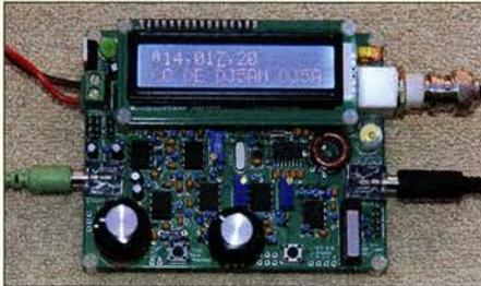
Bereits seit Juli 2017 ist der CW-Transceiver QCX bei QRP Labs erhältlich. Das Interesse an diesen Monobändern ist seitdem weiter gewachsen und Bausätze sind nur nach Wartezeit erhältlich. Der Beitrag beschreibt den Aufbau, die grundlegenden Funktionen und den Abgleich mit Bordmitteln.
