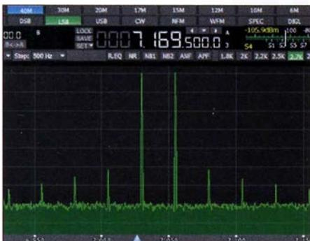
**Bild 11:** Intermodulationsprodukte eines Zweitonsingals ohne *Dithering*
