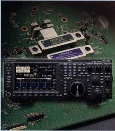
Der Kenwood TS-890S ist ein 100-W-Kurzwellentransceiver mit 6 m und 4 m, der den Anspruch extremer Großsignalfestigkeit erhebt. Dazu wurden alle Register eines analogen Empfängerkonzepts mit DSP-Signalverarbeitung gezogen: Abwärtsmischung, hochwertige Roofing-Filter (s. Hintergrund, 270-Hz-Filter optional), sehr rauscharmer Oszillator und besonders großsignalfester 1. Mischer.
