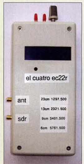
Fertig aufgebauter FM-Transceiver **EI Cuatro EC22r**
