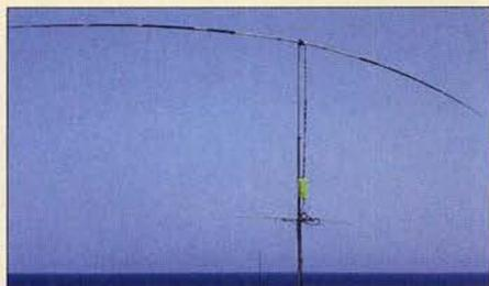
Ausgehend von den physikalischen Grundlagen eines Halbwellendipols werden im Beitrag verschiedene Aufbauvarianten erörtert. Die Diskussion mündet schließlich in einen aperiodischen Dipol mit etwa 2 x 7 m Länge, der über eine Zweidrahtleitung und einen Antennenkoppler gespeist wird. Dieser lässt sich horizontal (Bild) oder vertikal betreiben. Foto: DK7ZB 1044
