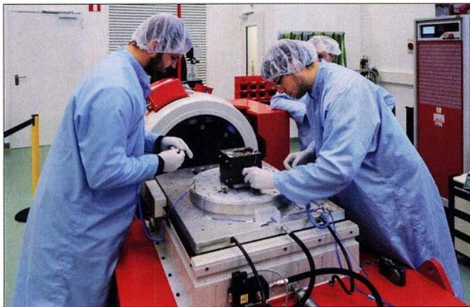
**Bild 6:** Befestigung des CubeSat OUFTI-1 auf einem der kleineren Schütteltische des ESTEC
