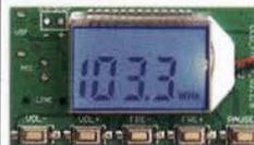
FM-Transmitter-Modul mit Stereodekoder, Line-Eingang, Mikrophon und digitaler Frequenzanzeige
