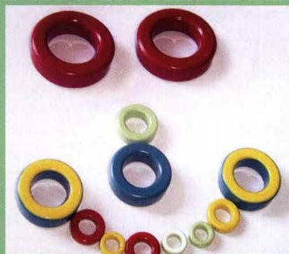
Eisenpulver-Ringkerne zum Herstellen von Spulen, Drosseln und Balunen.
