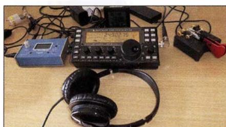
Aktuell verwendete Stationsausrüstung mit der CWmaschine von Begali zum Geben und Loggen, dem Elecraft KX3 und einer Einarm-Taste Mono von Begali; zum Zubehör gehören ein Überspannungsschutz (links oben) Netzteile und eine auf UTC umgestellte DCF77-Funkuhr. Foto: HB9BMY
