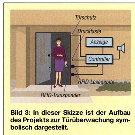
**Bild 3:** In dieser Skizze ist der Aufbau des Projekts zur Türüberwachung symbolisch dargestellt.
