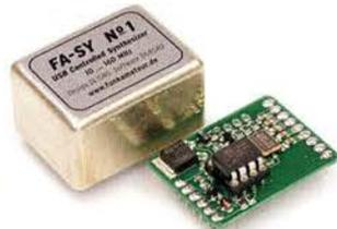
FA-SY 1-Bausatz für einen USB-steuerbaren Universal-Oszillator für Frequenzen von 10 bis 160 MHz. Herzstück ist ein SiLab-IC Si570 in CMOS-Version ( $\pm 31,5$  ppm, mit der On-board-Heizung reduzierbar). Größe 36 x 27 x 19 mm, alle SMD-Teile bestückt. Stromversorgung über USB oder/und 12 V extern. Die FA-SY 2 und 3 basieren auf einem Si570 mit LVDS-Ausgang.
