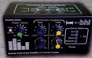
**20W Audioverstärker + parametrischer Equalizer. Bessere Verständlichkeit des Funksignales. Optional mit Bluetooth, optional mit Rauscherunterdrückung.**
