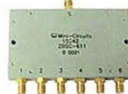
Splitter/Combiner, 6 Eingangs-/Ausgangsports, 1 Summenport, 10-200 MHz, SMA-Buchsen, gebraucht, geprüft
