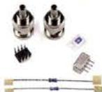
Alle zusätzlichen Bauelemente zum Einbau eines Richtkopplers und eines zweiten logarithmischen Detektors zur gleichzeitigen Messung und Anzeige von  $S_{11}$  (Reflexion) und  $S_{21}$  (Transmission)
