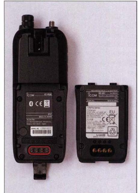
**Bild 6:** Der mitgelieferte Akkumulator wird hinten aufs Gerät gesteckt und verriegelt.
