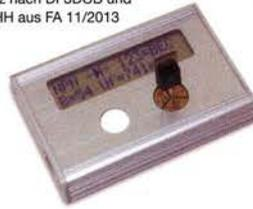
Verbesserte Version des Bausatzes nach DF3DCB/DH8GHH. Jetzt mit 3,7-V-Li-Ionen-Akkumulator, beleuchtetem LC-Display und neuer Firmware.
