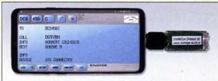
Der DVmega DVstick 30 mit der freien Software BlueDV erlaubt es lizenzierten Funkamateuren – etwa außerhalb des Einzugsbereichs lokaler DV-Repeater – via Internet auf D-STAR- und DMR-Netze zuzugreifen und Sprechverbindungen zu führen.
