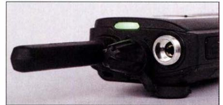
Geschützt unter einer Gummikappe liegt eine Buchse zum Anschluss eines Lautsprechermikrofons oder eines *Headsets*.
