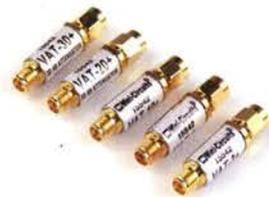
Kommerzielle Dämpfungsglieder von Mini-Circuits für DC bis 6 GHz, SMA-Stecker/-Buchse (m/f), maximale Eingangsleistung 1 W.
