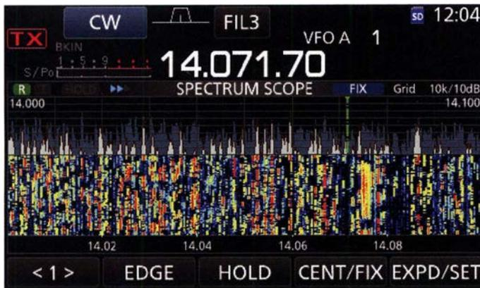
**Bild 1:** So präsentiert sich das Bandscope des IC-7300 in voller Pracht und maximaler Größe bei hoher Signaldichte auf dem Band.
