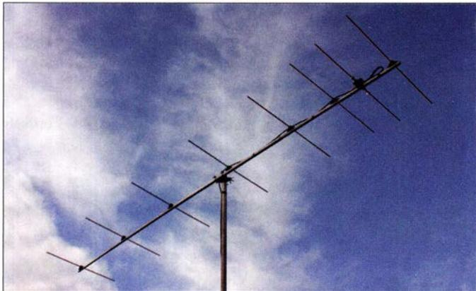
**Bild 1:** Fertig montierte, von DK7ZB neu entwickelte Antenne mit nur acht Elementen
