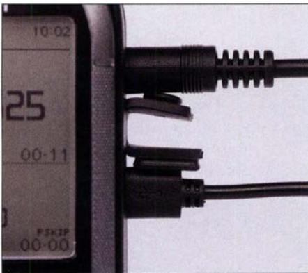
**Bild 4:** Auf der rechten Gehäusesseite schützen Gummabdeckungen die Buchsen für NF-Ausgang und USB-Schnittstelle.
