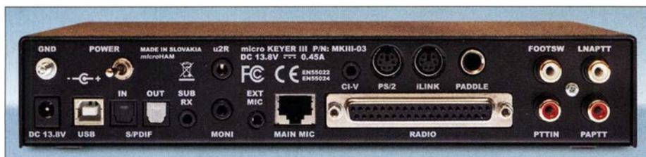
Auf der Rückseite findet sich kaum noch Platz für Erweiterungen. Leider wurde die Buchse fürs Zweitmikrofon nach hinten verlegt. Neu sind die optischen S/PDIF-Anschlüsse. Die Buchse u2R dient zur Verbindung mit anderen MicroHam-Geräten. Hier lassen sich Haupt- und Zweitempfängersignale für eigene Anwendungen abgreifen.
