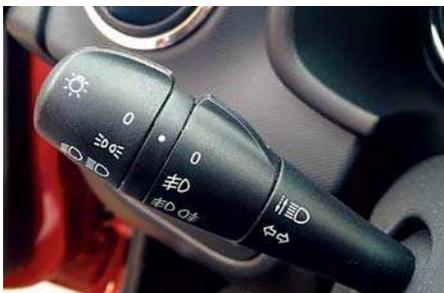
На 6000 км ближний свет фар перестал включаться из-за плохого контакта в подрулевом рычажке. Ремонт не потребовался: через некоторое время неисправность пропала и больше не проявлялась.
