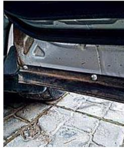
У моего кроссовера Nissan X-Trail T31 после восьми лет эксплуатации начали отскакивать крепления уплотнителей на нижних кромках дверей. Вместо штатных заклепок в отверстия двери вставил пластиковые дюбели диаметром 5 мм и длиной 20 мм. Закрепил уплотнитель саморезами длиной 17 мм. Крепление получилось очень прочное. Этот способ могут взять на заметку и владельцы других автомобилей.
