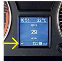
На панели приборов появилась пиктограмма включенной передачи.
