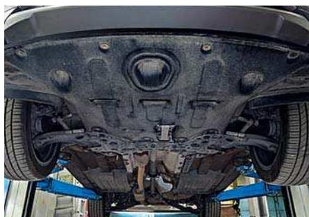
Дорожный просвет **Туссана** – 180 мм. Но от контакта с земной твердью его защищает всего-навсего фетровый пыльник.
