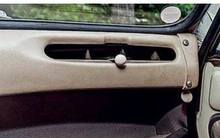
Из перчаточного ящика торчит клюка вентиляционной заслонки.
