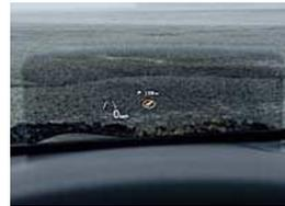
Проекция приборов на выдвинутой экранчик – технология устаревшая, но многим такое решение понравится.
