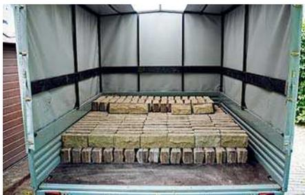
Наш груз – клинкер и облицовочный кирпич. Приподняв тент, можно грузить машину с трех сторон. Стойки тента не крадут внутренний объем. Поскольку они опираются на борта, последние не откинуть, пока не демонтируешь каркас.
