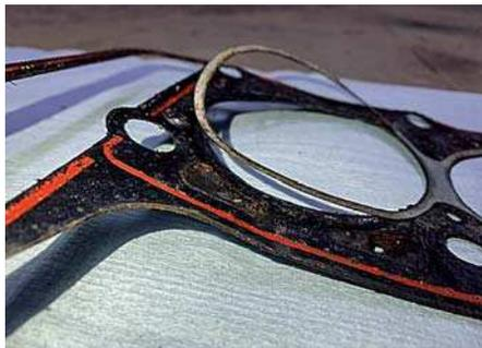
**Виновница выхода из строя многих компонентов системы охлаждения. Прокладка головки блока отслужила 95 000 км и начала потихоньку сифонить. Постепенно прогорела полностью, пустив антифриз в первый и четвертый цилиндры.**
