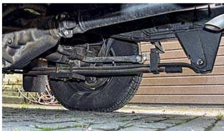
Так выглядит Профи с максимальной нагрузкой. Рессоры распрямляются, шины сплющиваются даже при рекомендованном повышенном давлении. При этом не возникает ощущения, что задняя подвеска трудится на пределе.
