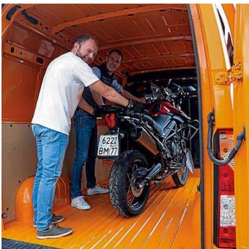
В грузовом отсеке объемом 11 кубов – множество крюков для фиксации груза. Мы легко закрепили 280-килограммовый мотоцикл. Распахивающиеся на 270° двери – опция, которая обойдется в 8000 рублей.
