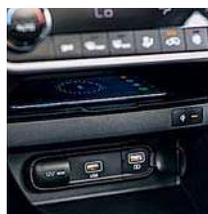
Под блоком климат-контроля – очень удобная и большая площадка для беспроводной зарядки телефона, куда с запасом входит Samsung S10 Plus. Ниже – 12-вольтовая розетка и два USB-разъема.
