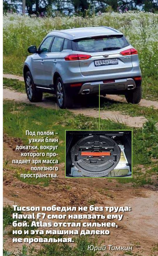
Под полом – узкий блин доклатки, вокруг которого пропадает зря масса полезного пространства.
