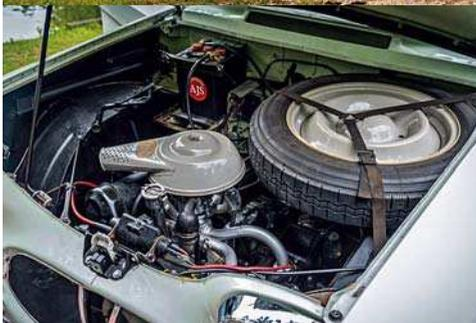
Двухцилиндровому моторчику места более чем достаточно. Потому с ним соседствует запаска.
