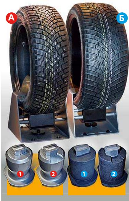
Шины Continental IceContact 3 с посадочным диаметром до 16 дюймов **A** включительно имеют алюминиевые шипы (для бокового **1** и продольного **2** сцепления), а начиная с 17 дюймов **B** – обрезиненные (для бокового **1** и продольного **2** сцепления).
