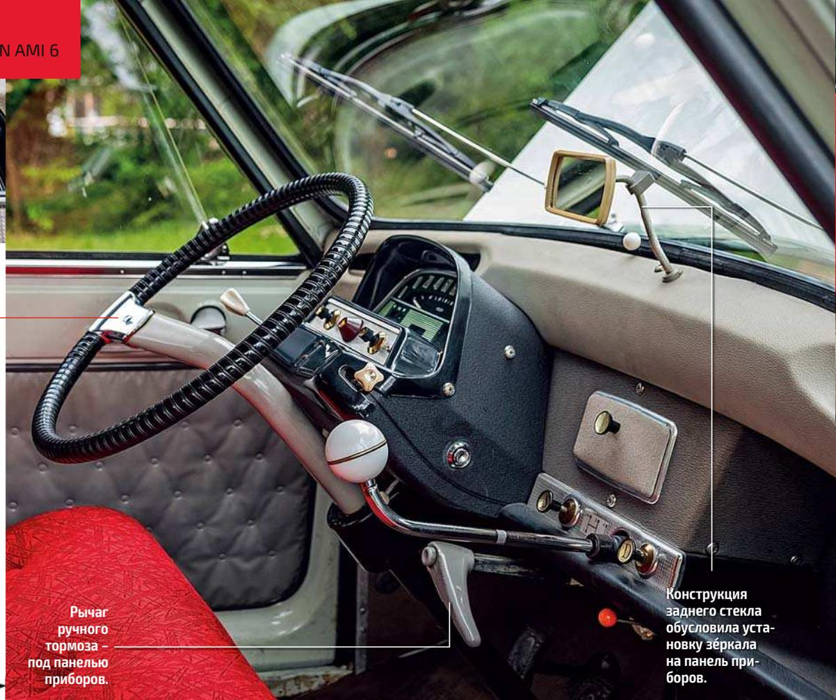
Рычаг ручного тормоза – под панелью приборов.
