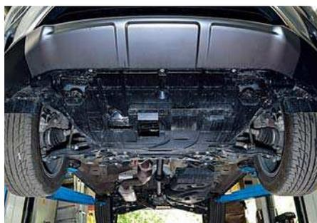
Дорожный просвет под пластиковой защитой **Атласа** – всего 165 мм. Негусто, зато с углами въезда и съезда всё в порядке.
