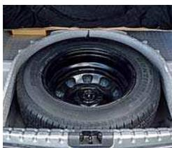
**В багажнике Дастера – удобная ниша под канистру с незамерзайкой, а под полом – полно-размерная запаска. Измеренный нами объем – 340 литров, средний в тесте.**
