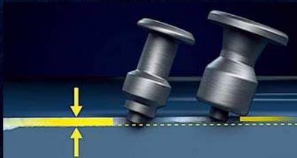
При испытаниях шины позволили проходить трассы на несколько секунд быстрее, сокращая тормозной путь на 3,7 метра. За устойчивость на льду отвечают шипы особой формы, а за отвод снега и стабильное поведение – новый направленный рисунок протектора с ребром жесткости и широкими секторами.
