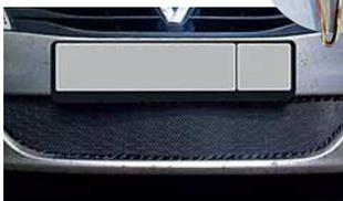
от насекомых, сколько от камней) нижняя часть радиатора, расположенная за воздухозаборником в бампере. Смятые пластины снижают эффективность радиатора. По размерам отверстия я вырезал защиту из металлической сетки с ромбовидными ячейками 4 × 8 мм, края обрбил изолентой.
