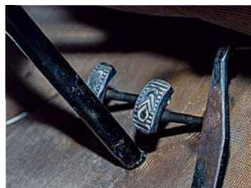
Забавная «кочерга», которой переключают передачи, требует некоторого привыкания. Ее надо вытягивать из панели, поворачивать и вновь вставлять, но спустя какое-то время это уже не раздражает.
